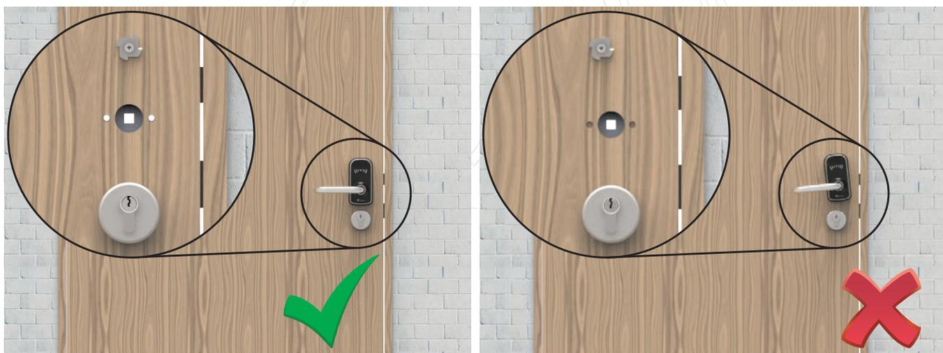
En passant la PaxLock Pro à travers la porte pour l'installer, l'appareil doit se trouver complètement à plat contre la face de la porte. Si ce n'est pas le cas, les trous dans la porte auront peut-être besoin d'être ajustés.
