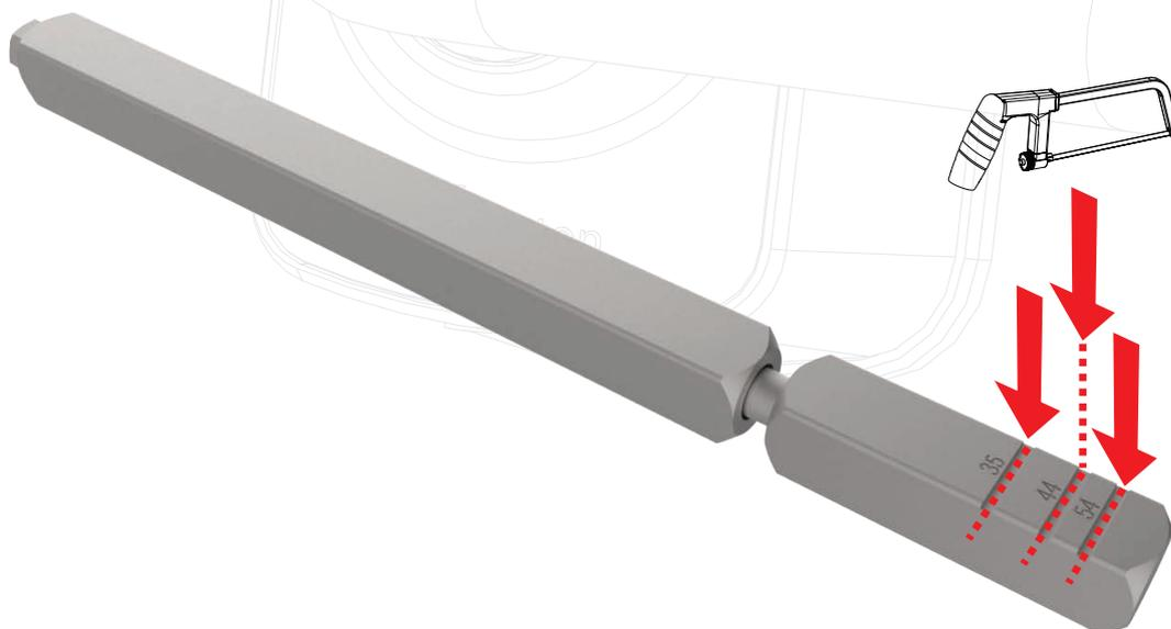
Il est important de noter que lors de l'installation de la serrure Union HD72 les vis sur le carré doivent toujours être positionnés à l'intérieur de la porte car ceci indique la direction de sortie de secours. S'ils doivent être déplacés de l'autre côté du bloc serrure, ils doivent être retirés chacun son tour.
